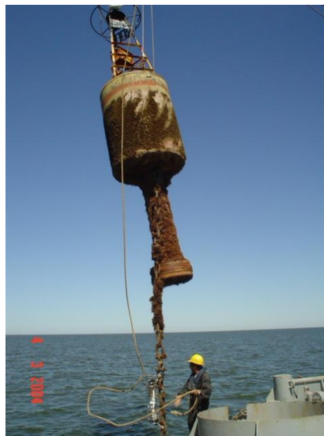
Foto de la recuperación de la Maniobra de ADCP trabajando con el e ROU 21 Sirius
